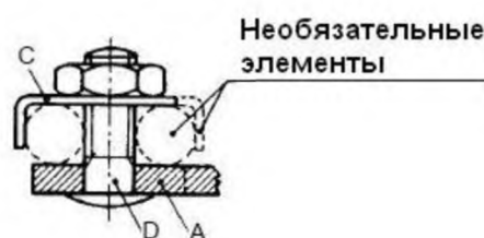
б) пример винтового зажима с передачей давления головкой винта через промежуточную деталь
