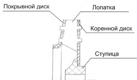
Рисунок А.7 – Крепление лопаток радиальных вентиляторов с помощью штифтов
