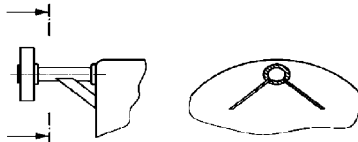
Рисунок 20 — Типовая конструкция ребер жесткости
