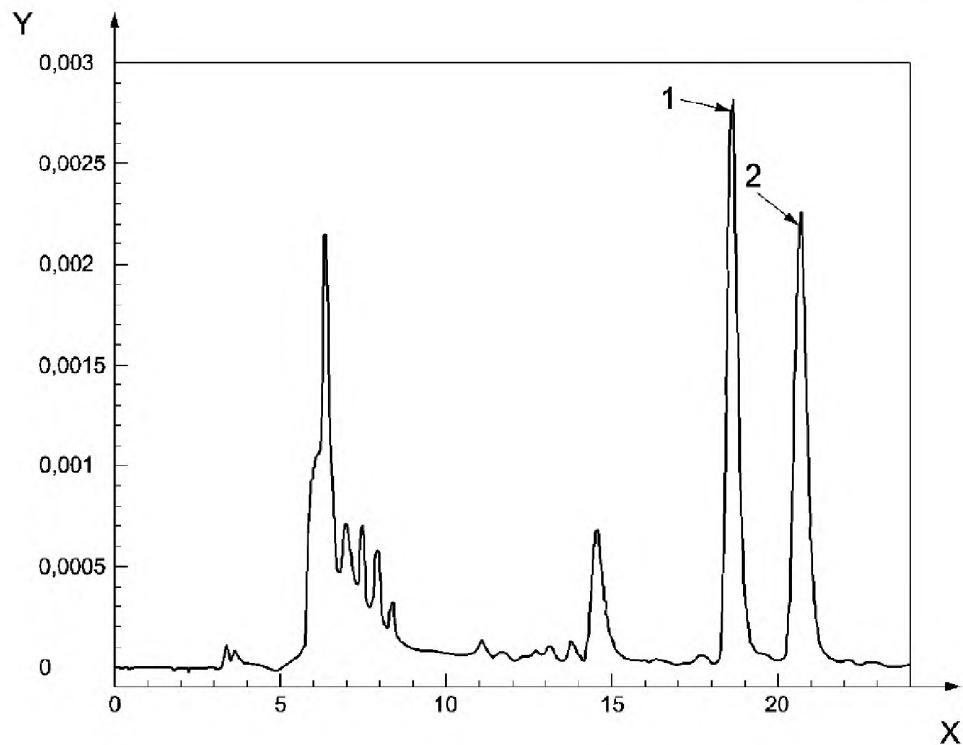
Рисунок С.2 – Типичная обращенно-фазовая хроматограмма фракции экстракта сухого молока (CRM 421), выделенная на стадии полупрепартивной хроматографии между 11,5 и 12,5 мин (см. рисунок С.1)
