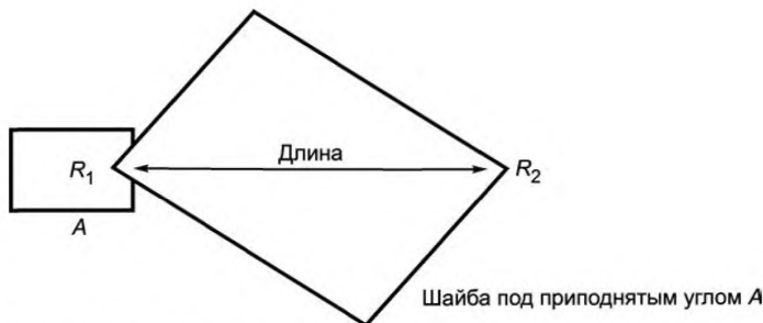
Рисунок 9 — Схема проведения измерения скручивания
