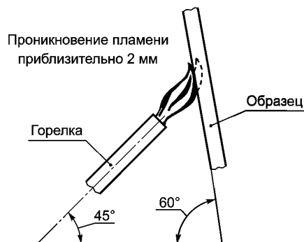
е) Испытание с использованием горелки игольчатого типа. Виды сбоку на тест-плату и горелку
