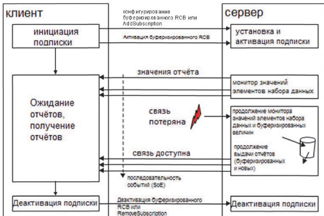
Рисунок 6 – Концепция блока управления буферизированным отчетом
