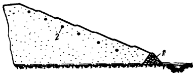
Рис. 44. Дренажная призма с трубчатым дренажем
