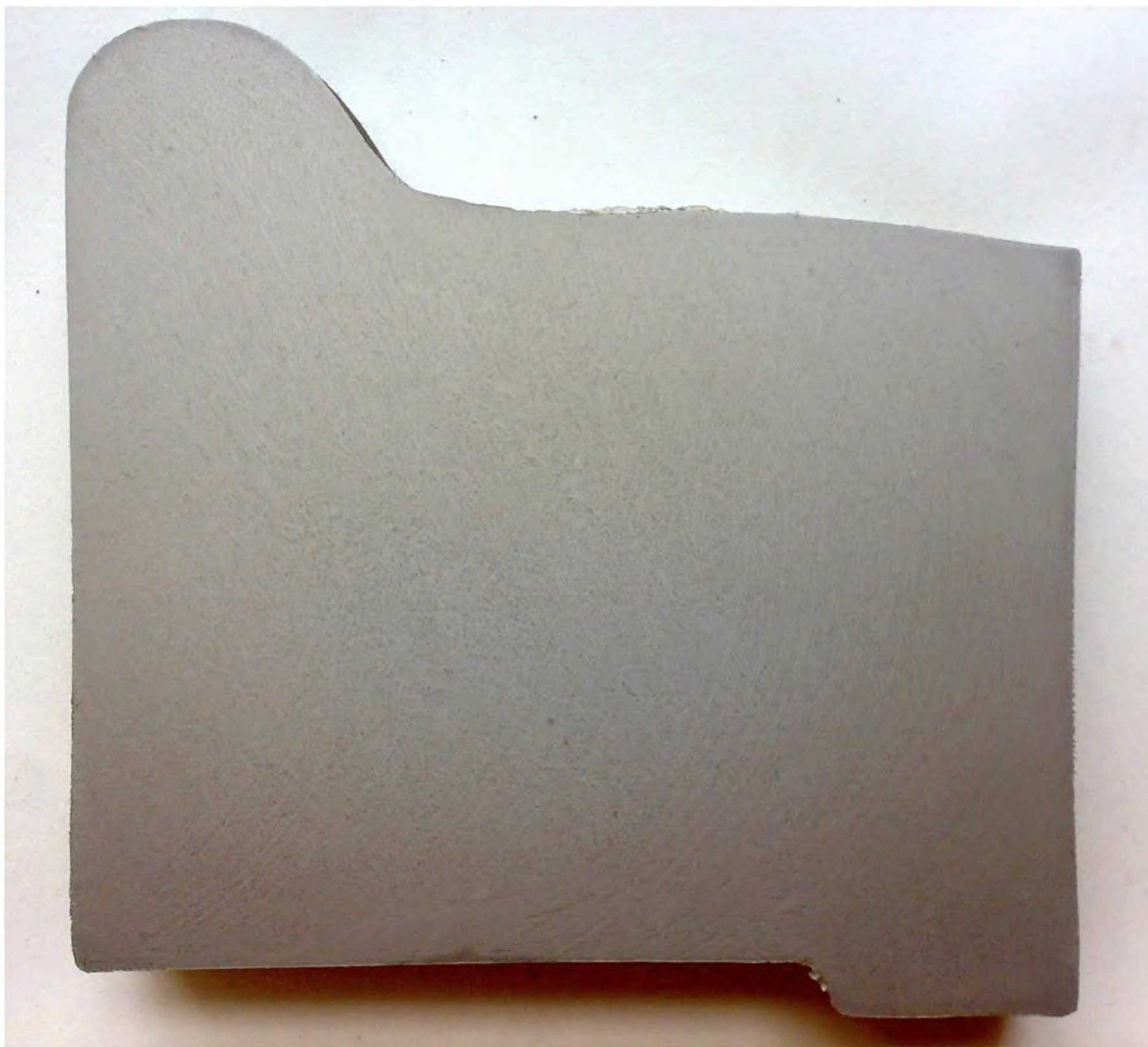
Рисунок А.4 – Эталон № 4 (однородная макроструктура биндажа)
