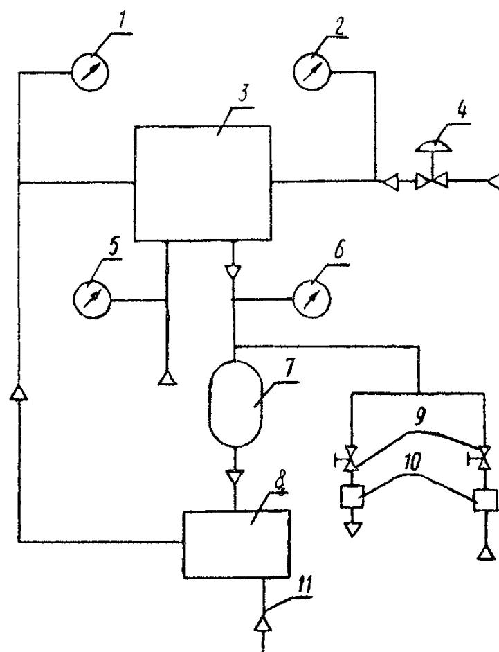
1 — манометр контроля переменного значения регулируемой величины, 2 — манометр контроля задающего значения регулируемой величины, 3 — регулирующее устройство, 4 — задатчик, 5 — манометр контроля давления питания, 6 — манометр контроля выходного давления, 7 — емкость, 8 — реле суммирования, 9 — вентиль, 10 — ротаметр, 11 — переменное смещение
