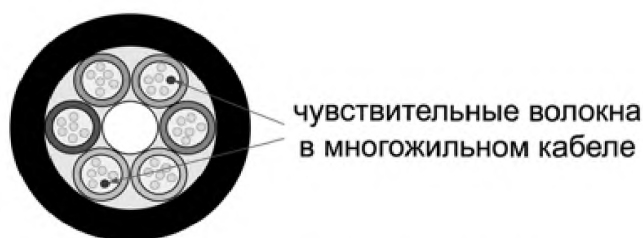
Рисунок 69 - Схема многожильного волоконно-оптического кабеля фирмы FFT
