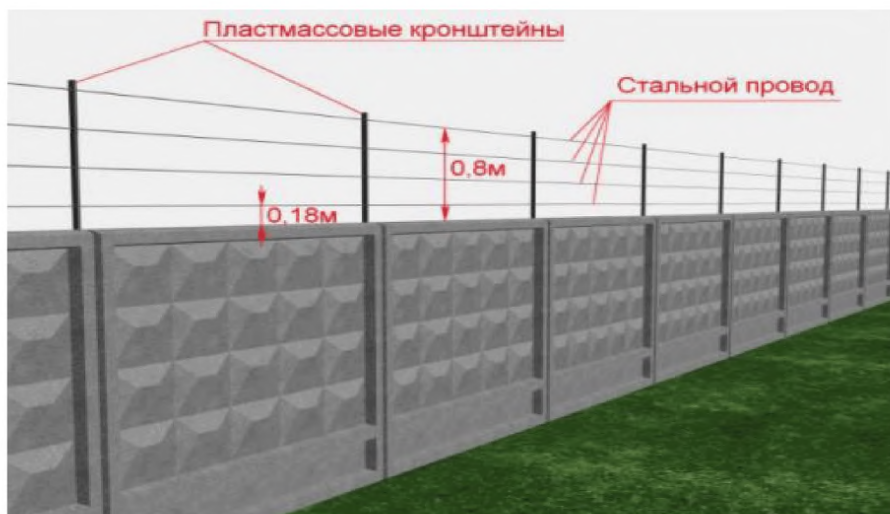
Рисунок 20 – Установка ЧЭ на железобетонном заборе
