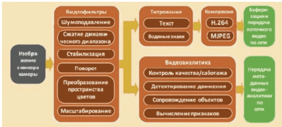
Рис. 1А - Конвейер обработки видео интеллектуальной IP - камеры
