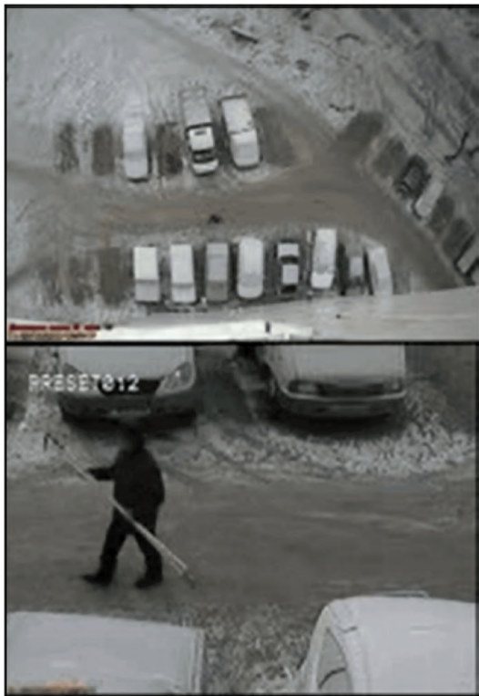
Рис. 41 - Обнаружение движения человека (верхний кадр) и разворот на него поворотной камеры с транс-фокатором
