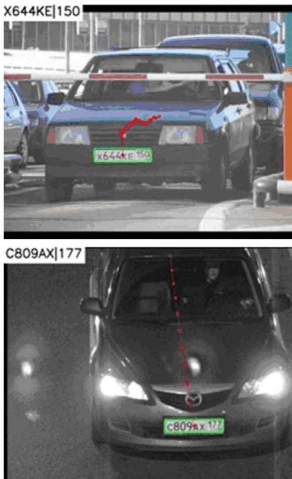
Рис. 63 - Работа модуля компании «СИНЕЗИС» по распознаванию автомобильных номеров
