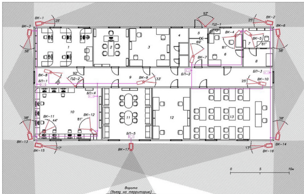
Рис. 14 Схема системы видеонаблюдения для ПЧО подразделения вневедомственной охраны с возможными зонами действия детектора движения
