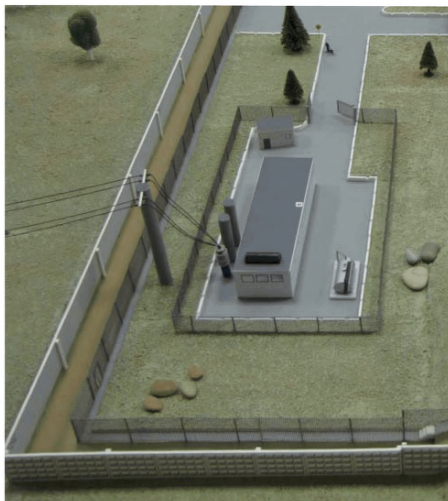
Рис. 66 - Схема ввода ЛЭП на объект охраны
