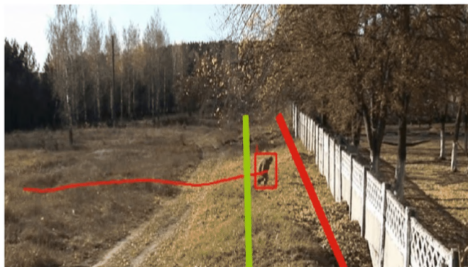
Рис. 64 - Пример обнаружения движения нарушителя в запретной зоне
