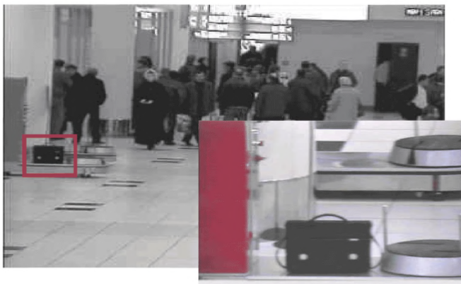
Рис. 47 - Распознавание оставленного предмета модулем «Orwell 2k-City»
