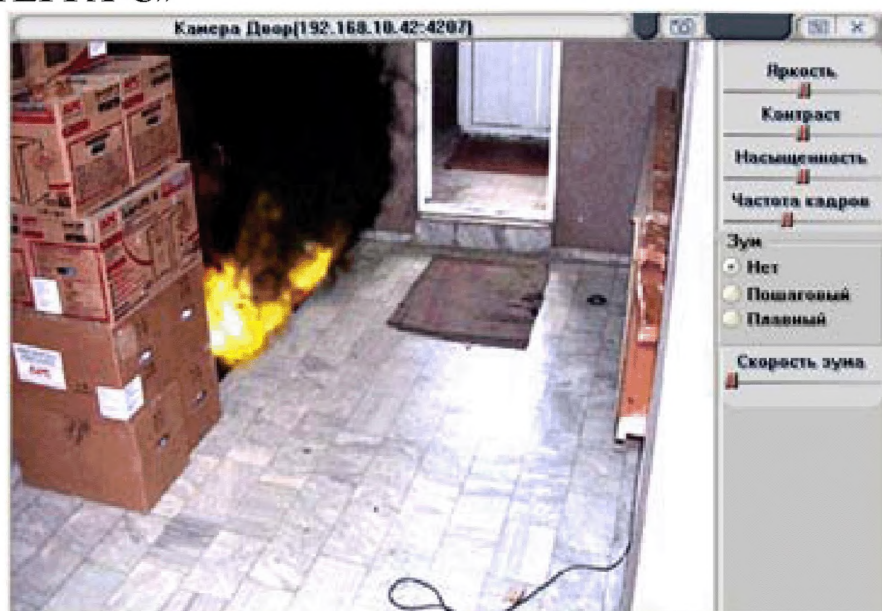
Рис. 75 - Работа видеодетектора дыма и огня компании «ИНТЕГРА-С»
