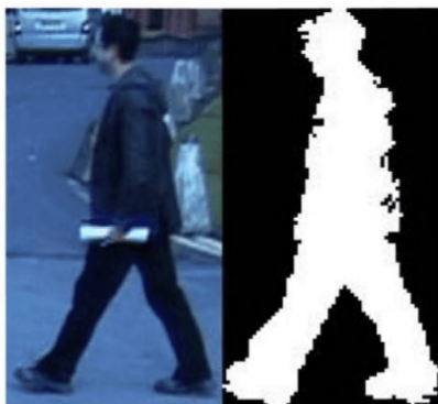
Рис. 43 - Классификация движущегося объекта системой цифрового видеонаблюдения компании «СИНЕЗИС»
