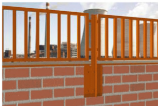
Рис. 2.12. Примеры увеличения высоты основного ограждения посредством использования дополнительного верхнего ограждения
