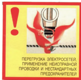
Неисправный предохранитель с «жучком»
