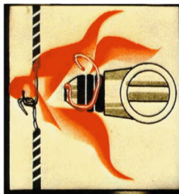
Неисправный предохранитель с «жучком»
