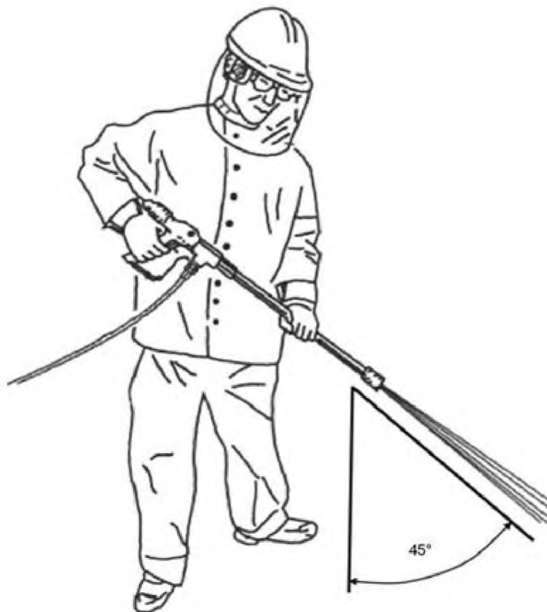
Рисунок DD.5 – Рабочие условия. Положение распыляющего устройства
