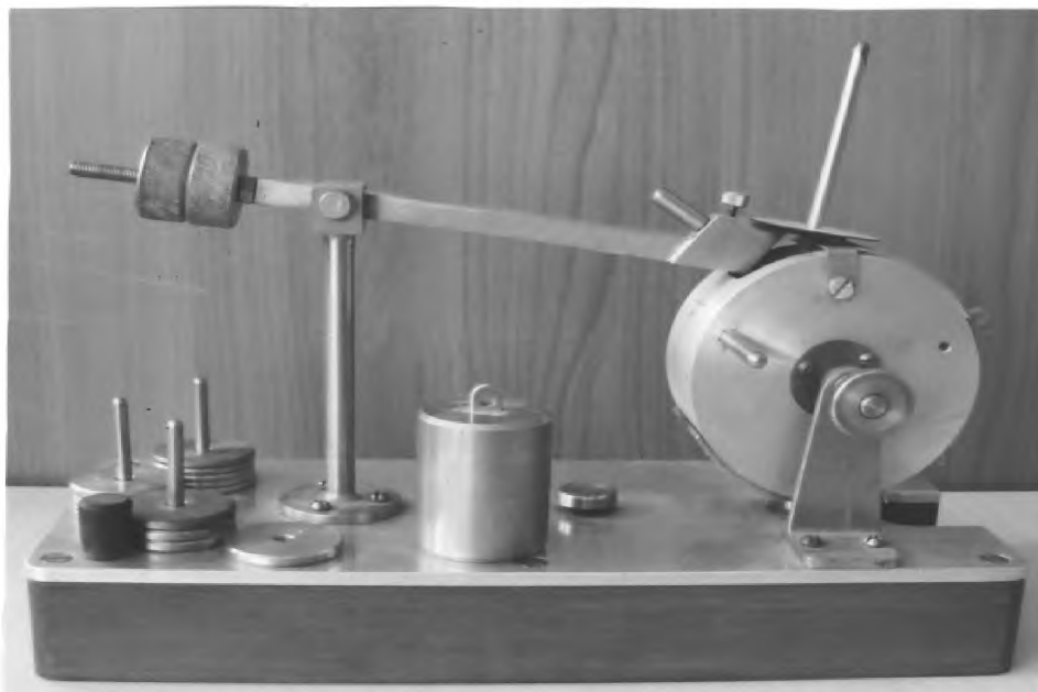
Рисунок 2 – Прибор для определения чувствительности спичек к воспламенению
