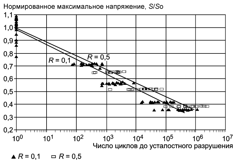
Рисунок Д.2 — Характерные усталостные кривые S — N для композиционного материала на основе стекловолокна
