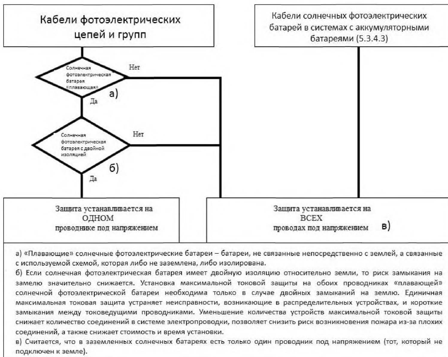
Т а б л и ц а 5 — Требования к расположению устройств максимальной токовой защиты в соответствии с конфигурацией заземления
