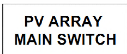
Рисунок Г.2 — Примеры знака, располагаемого на главном выключателе солнечных фотоэлектрических батарей (см. 10.4.2)
