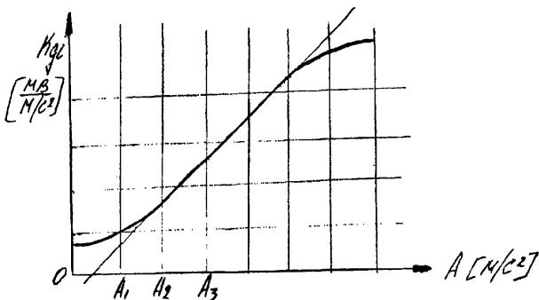
Строится график зависимости  $K_{gi}$  от амплитуды входного сигнала, определяется линейный участок характеристики с постоянным значением  $K_{gi}$  и отклонением от  $K_{gi}$  среднего участка не более 5%. Границы линейного участка (с учетом допуска) записываются в паспорт вибропреобразователя.
