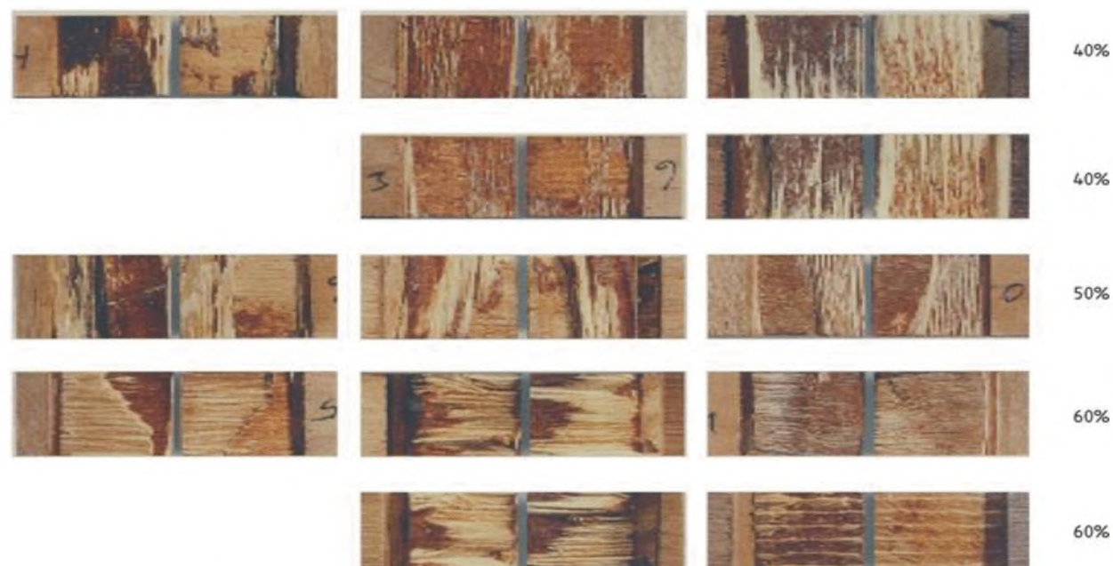
Рисунок Б.2 – Иллюстрации повреждения древесного волокна от 40 % до 60 %
