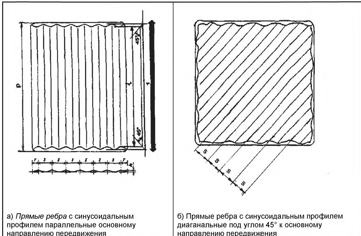
1 — основное направление передвижения;  $r$  — расстояние между краем указателя и осью, ближайшей к краю ( $0,5 \times s$ );  $s$  — расстояние между осями соседних прямых ребер с синусоидальным профилем;  $h$  — высота прямых ребер с синусоидальным профилем;  $l$  — длина прямых ребер с синусоидальным профилем;  $p$  — эффективная длина
