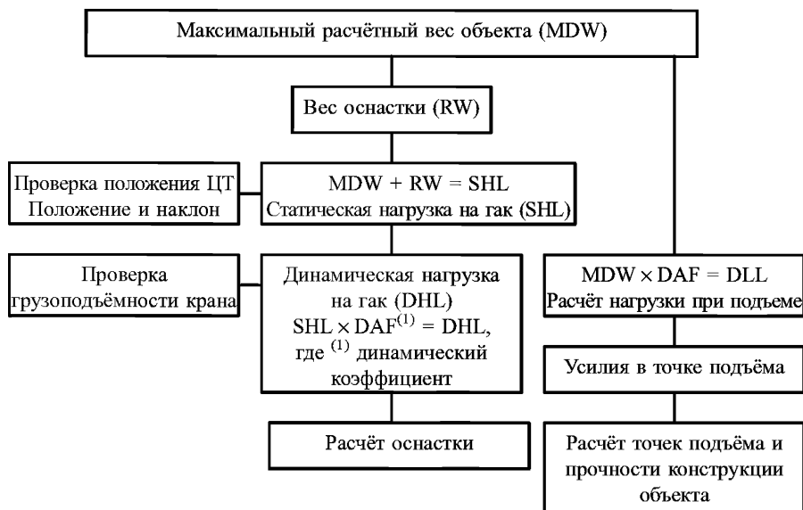
Рис. 3.1 Схема расчетов подъема объекта с использованием одного крана
