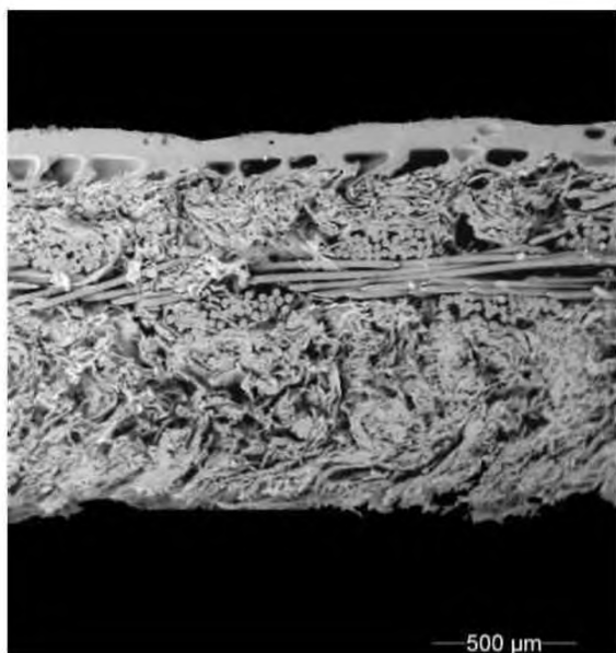
Рисунок А.11 — Сечение текстильного материала, покрытого кожевенными волокнами
