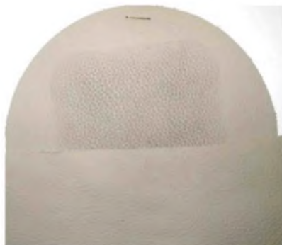
Рисунок А.1 – Пример результатов испытаний на загрязнение с абразивным держателем
