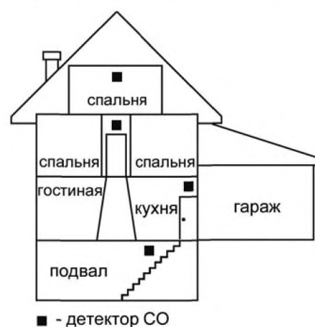
Рис. 1. Пример расположения извещателей СО в жилом здании
