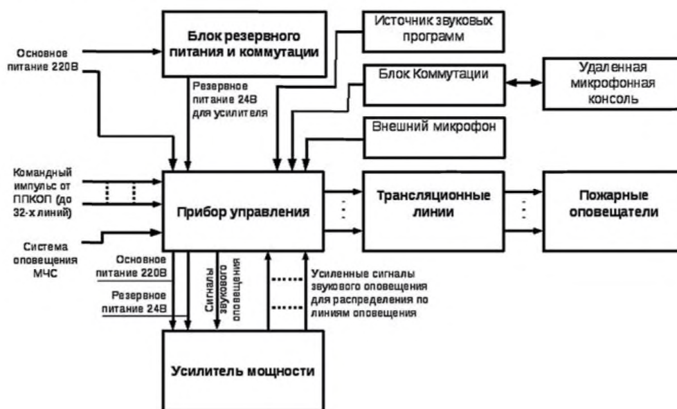
Типовая схема СОУЭ
