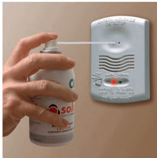
Рис. 2. Функциональный тест детектора СО
