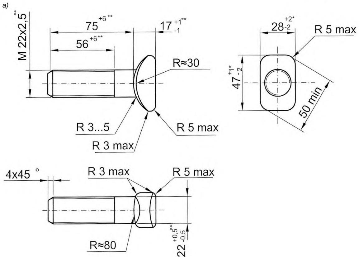
Вариант изготовления болта с облегченной головкой
