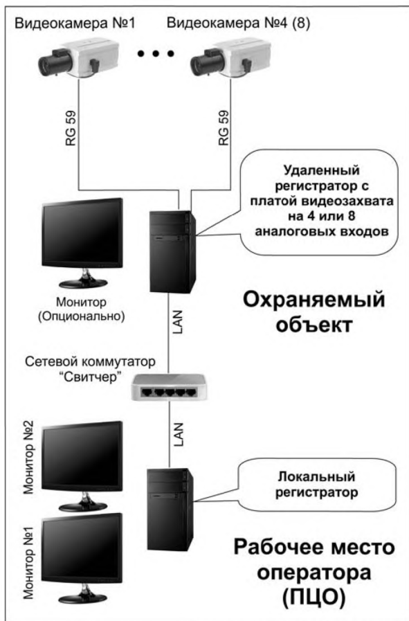
Рис. 2 - Структурная схема работы локального видеорежистратора с удаленным видеорежистратором по локальной сети с использованием проводного соединения на 4 или 8 аналоговых видеокамер
