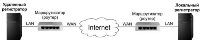
Рис. 6 - Структурная схема работы локального видеорегистратора с удаленным видеорегистратором в глобальной сети
