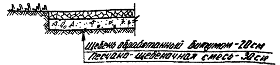
Конструкция твердого покрытия
