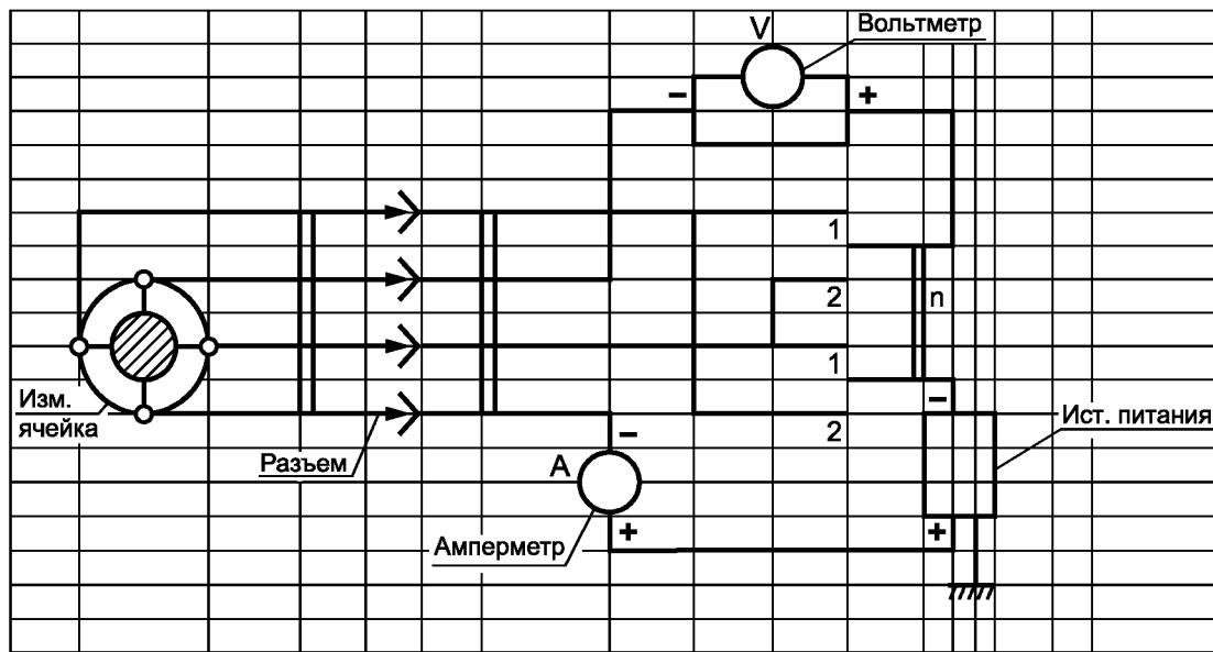
Если переключатель находится в положении 1, ток протекает между электродами 1 и 2, напряжение измеряют между электродами 3 и 4; в положении 2 ток протекает между электродами 1 и 4, напряжение измеряют между электродами 2 и 3.
