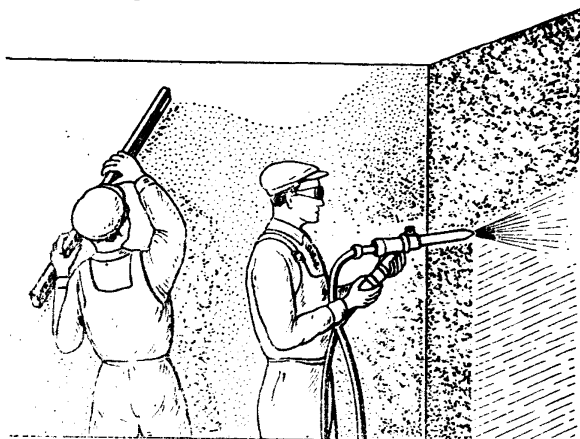
Рис. 6. Нанесение и разравнивание холодной асфальтовой мастики.
