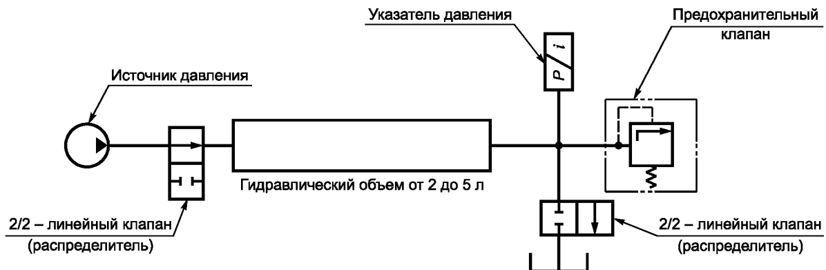
Рисунок А.1 — Схема испытаний (пример)
