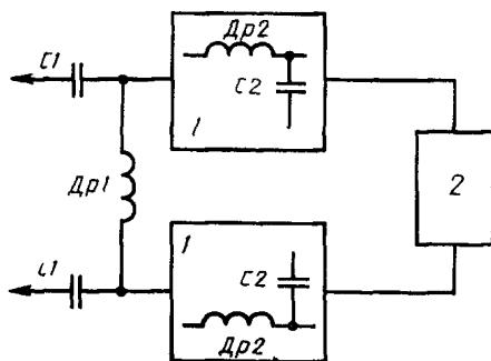
1 — разделительные схемы 2 — источник тока  $Др1$  — измеряемый дроссель индуктивностью  $L$  и  $C1$  — защитный конденсатор емкостью не менее  $100 \mu\text{F}$   $Др2$  — дроссель разделительной схемы индуктивностью не менее  $6 L$  и  $C2$  — конденсатор разделительной схемы емкостью не менее  $10 \mu\text{F}$
