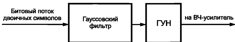
Рисунок 3 — Схема модулятора GMSK с ГУН
