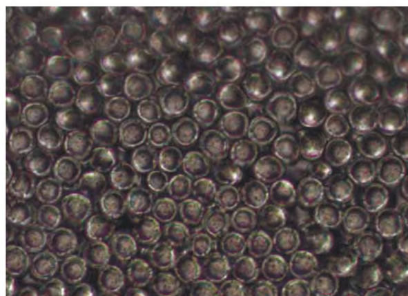
Рисунок В.27 — Оптическая микроскопия: поперечное сечение бикомпонентного полиэфир/ полиэфирного волокна
