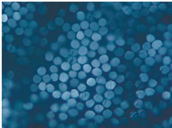
Рисунок В.1 — Акриловое волокно: поперечное сечение
