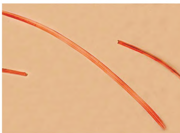
Рисунок В.14 — Высокомодульное волокно: продольный вид
