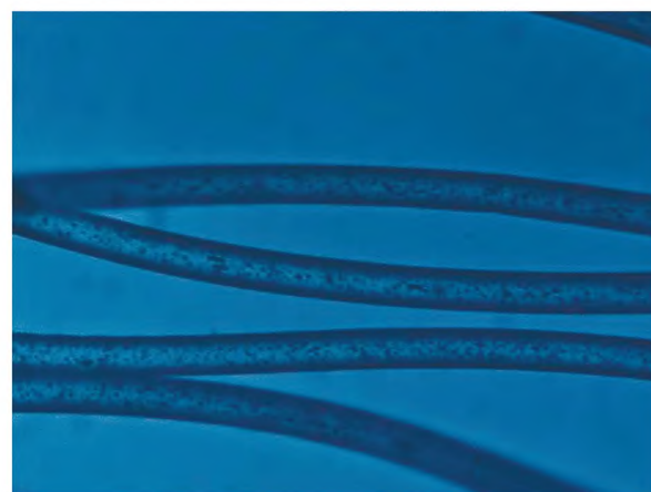
Рисунок В.16 — Полиэфир: продольный вид
