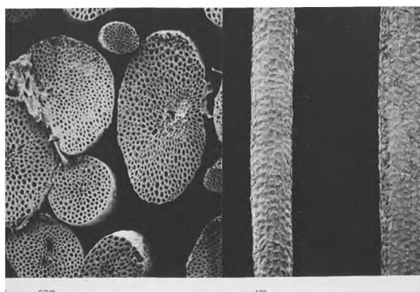
Рисунок С.13 — Волокно кокоса: поперечное сечение и продольный вид
