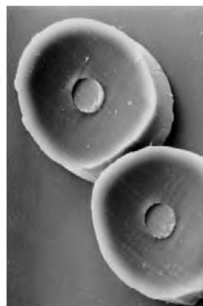
Рисунок С.41 — Бикомпонентные волокна: поперечное сечение конфигурации «сердечник/оболочка»
