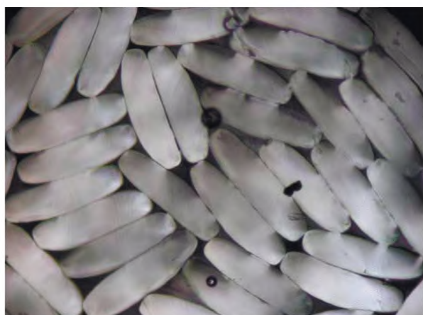
Рисунок В.7 — Эластолефин: поперечное сечение
