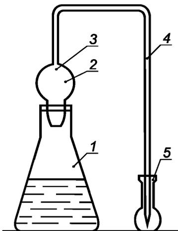
1 — колба Кн-2—250—40 ХС по ГОСТ 25336; 2 — вата, пропитанная раствором уксуснокислого свинца; 3 — расширение для ваты; 4 — соединительная трубка со шлифом; 5 — мерная колба вместимостью 25 см<sup>3</sup>
