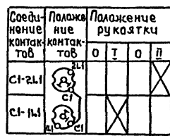
Диаграмма замыкания контактов пакетного переключателя „SA1“, „SA2“
