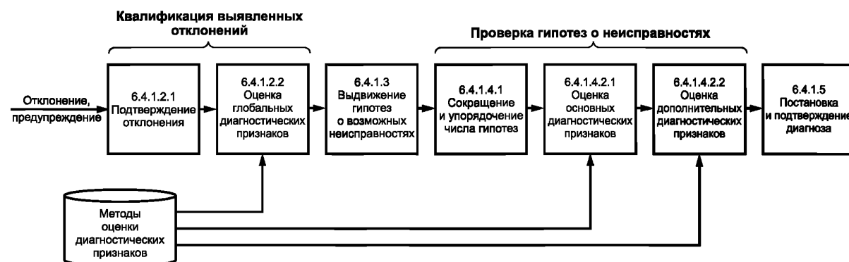
Рисунок 3 — Диагностирование на основе модели «неисправность — диагностические признаки»
