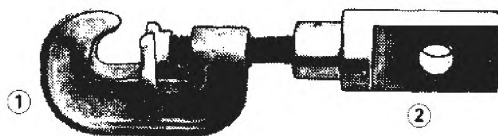
1 — натяжная головка; 2 — однолапчатая проушина
