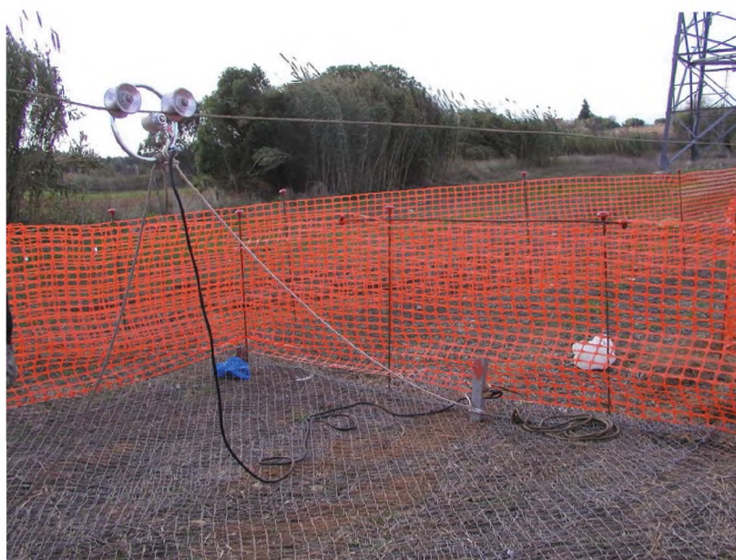
Пример использования ролика заземления
