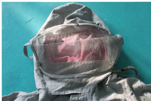
Защитная маска, электрически соединенная с проводящей одеждой
