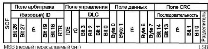
Рисунок 10 — Порядок передачи битов (базовый формат)
