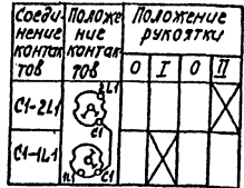
Диаграмма замыкания контактов пакетного переключателя "SA1", "SA2"
