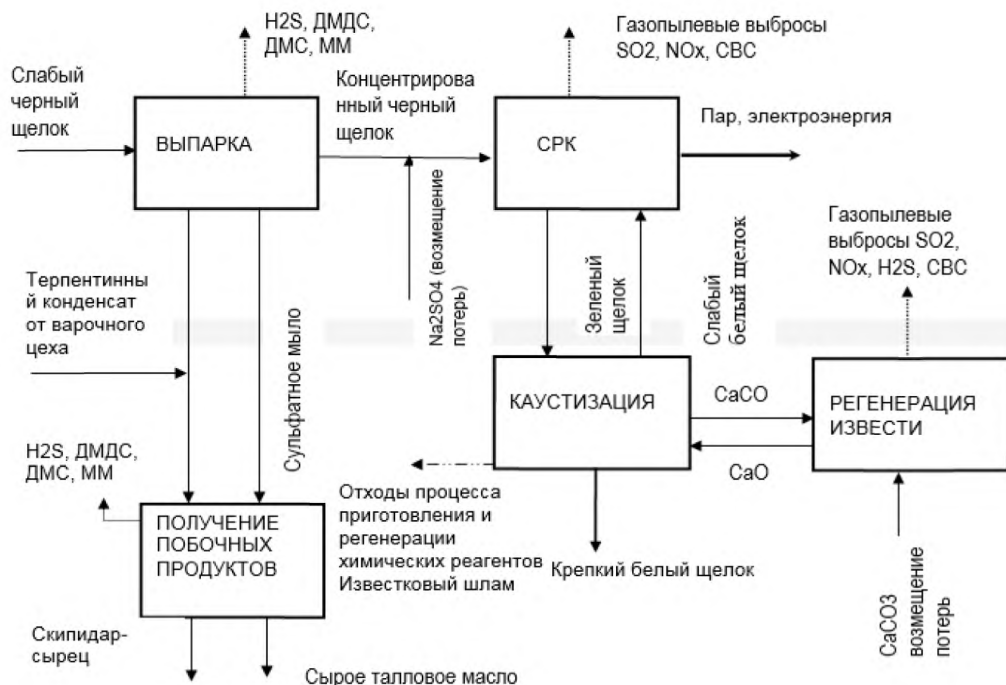
Рисунок 2.7 — Блок-схема процесса регенерации химикатов
