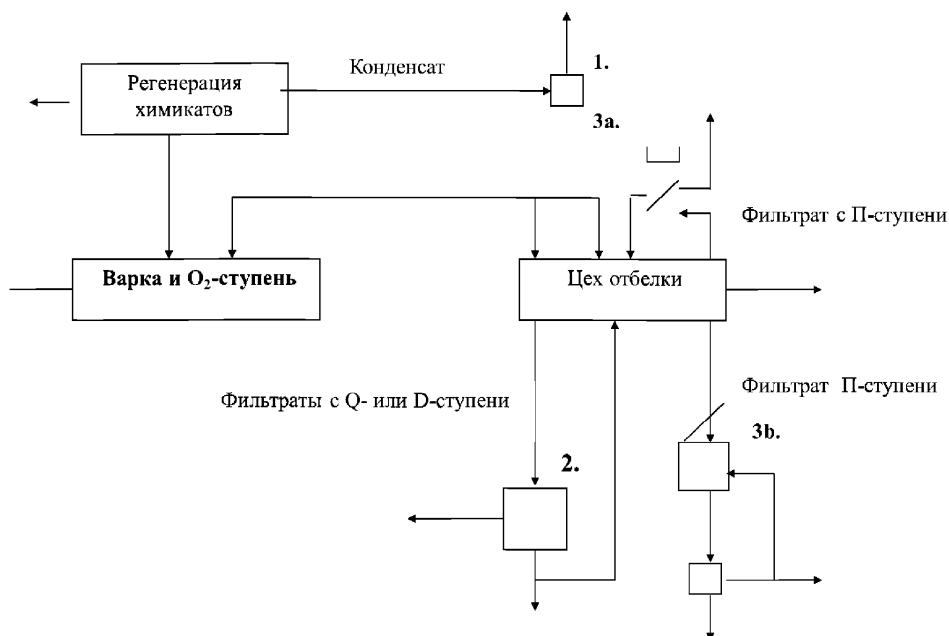
Рисунок 7.1 – «Почки» в стадии разработки - согласно проекта Европейского Союза по созданию технологии, работающей по замкнутому циклу при производстве беленой сульфатной целлюлозы:
