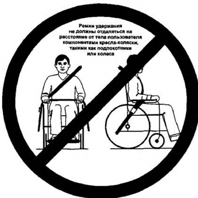
Рисунок 7 — Пример предупреждающей этикетки, иллюстрирующей ненадлежащее положение ремня удержания пользователя
