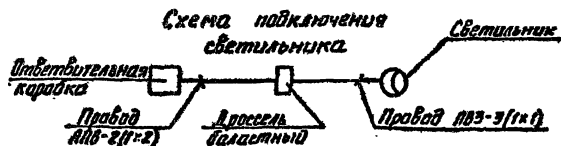
Установка светильника ПВЛМ-2х40 на кронштейне на стене
