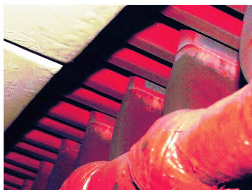
Рисунок А.13 — Износ, вызванный коронной активностью в проводящем и выравнивающем электрическую напряженность покрытиях, и соответствующая диаграмма PRPD
