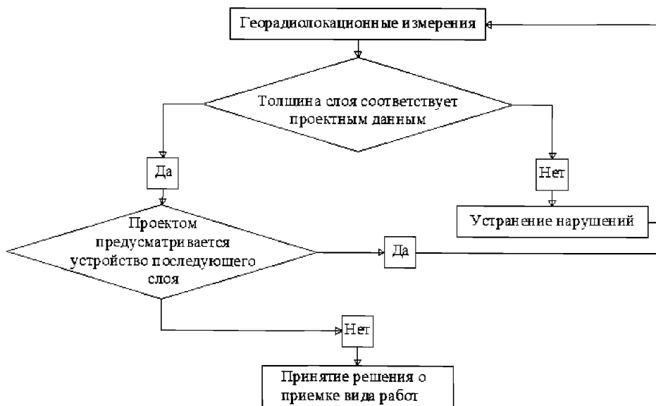
Рисунок А.1 – Алгоритм выполнения георадиолокационного операционного контроля
