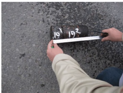
Рисунок 5 – Фотофиксация толщины асфальтобетонных слоев дорожной одежды
