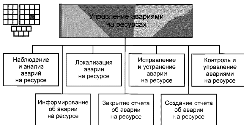
Рисунок 3 — Декомпозиция процесса 1.1.3.3 — «Управление авариями на ресурсах» на элементы процессов уровня 3
