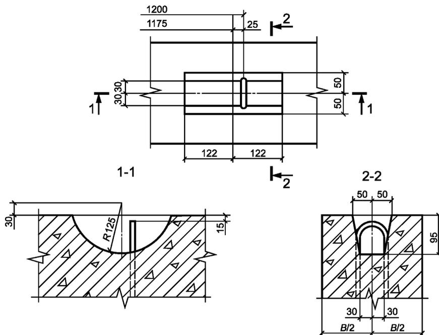
Рисунок 1 — Скрытое расположение монтажной петли
