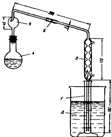
Рис. Прибор для дистилляции четыреххлористого германия.
