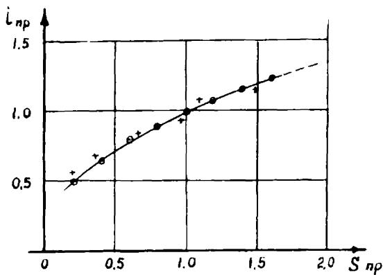
Рис. График зависимости  $I_{np} = f(S_{np})$ . Теоретические точки (o) рассчитаны для  $S_{np} = 0,2; 0,4; 0,6; 0,8; 1,2; 1,4; 1,6$ . Экспериментальные точки (+) рассчитаны по формулам (7) и (8).
