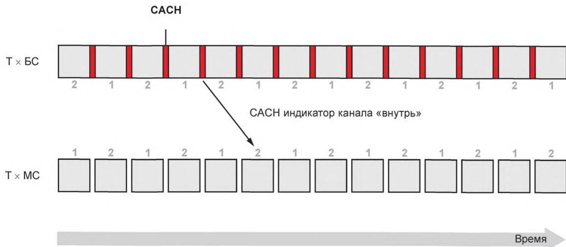
Рисунок А.7 — Синхронизация между пакетами САСН и «внутрь»
