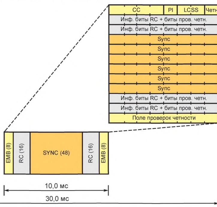
Рисунок А.18 — Формат автономного пакета направления «внутрь» RC канала
