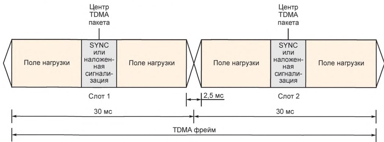
Рисунок А.4 — TDMA фрейм от источника МС
