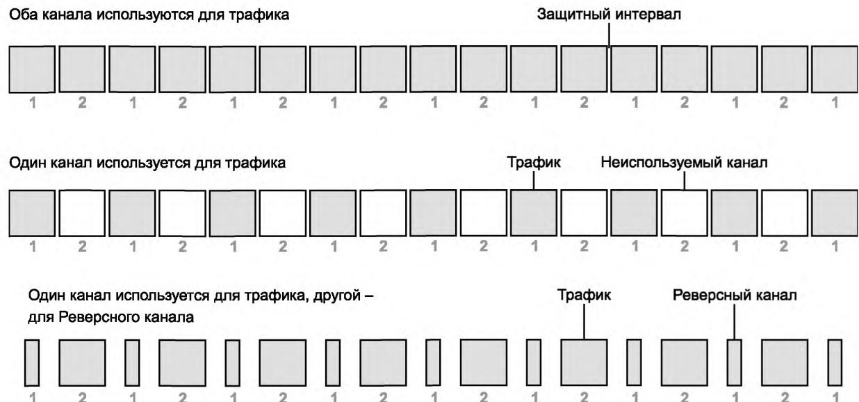
Рисунок А.9 — Канал трафика с защитным интервалом
