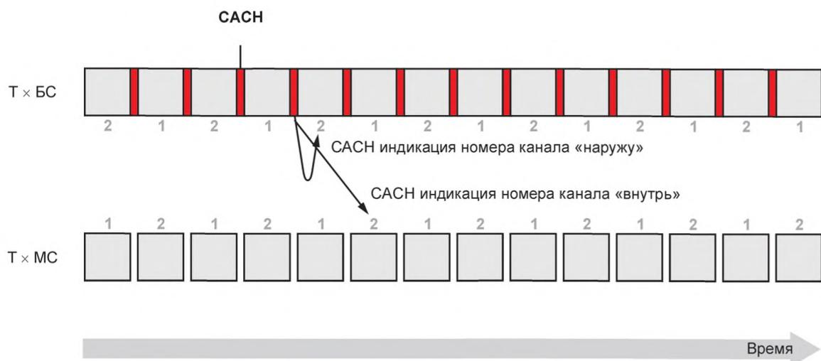
Рисунок А.8 — Синхронизация пакета САСН для индикации номера канала
