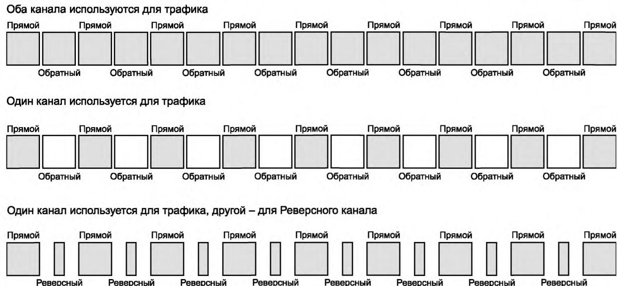
Рисунок А.10 — Двунаправленный канал
