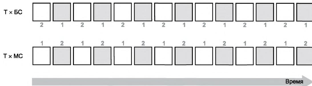
Рисунок А.13 — Диаграмма выровненной синхронизации канала
