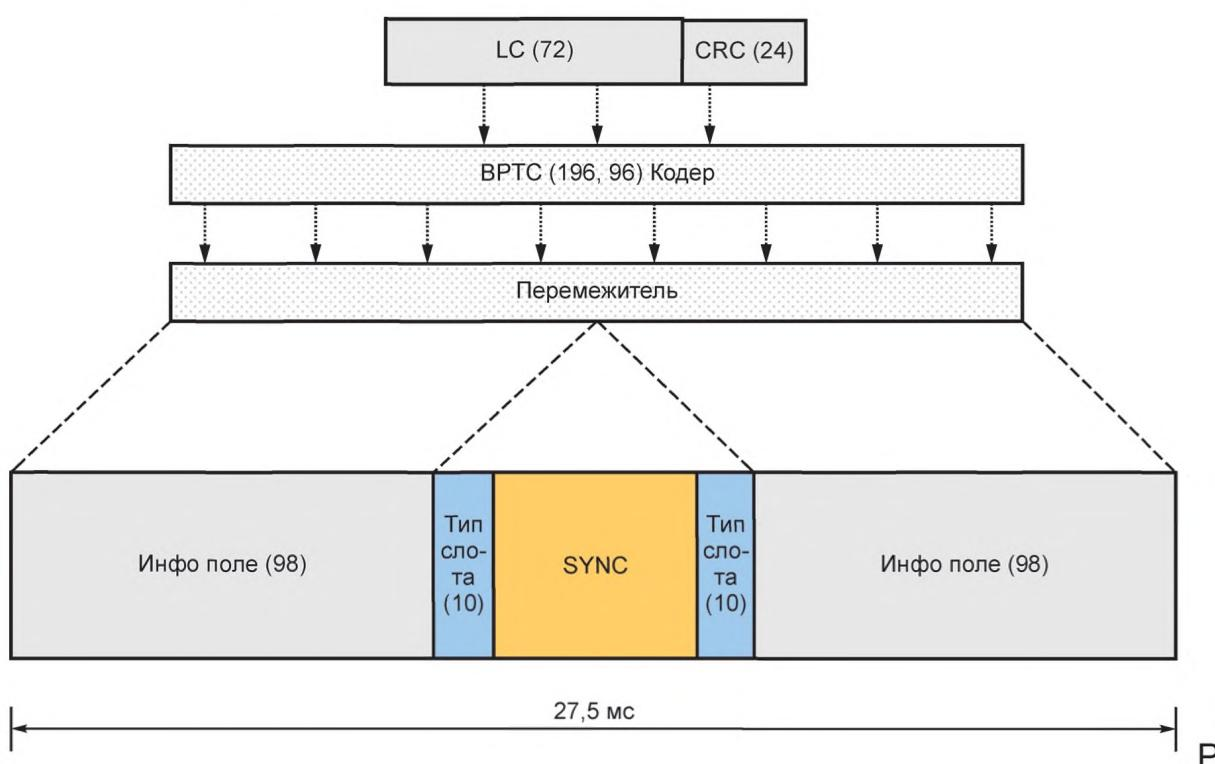
Рисунок А.22 — Формат LC пакета голосового заголовка
