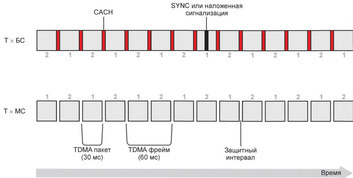
Примечание – В качестве примера синхронизация на рисунке относится к двум частотам БС.
