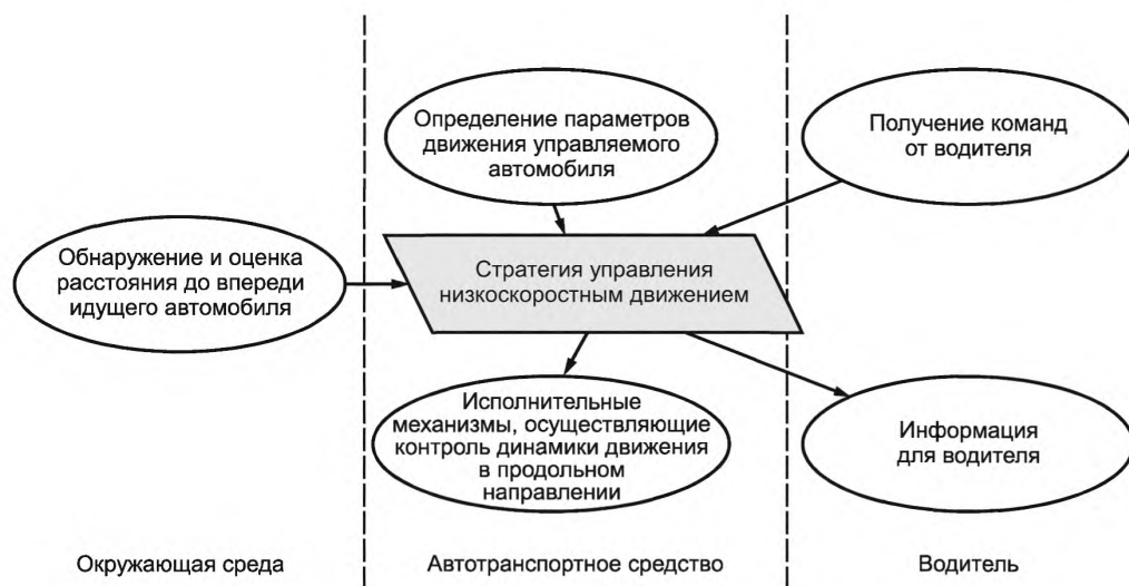
Рисунок 1 — Функциональные элементы системы LSF
